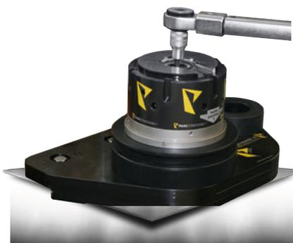
1. Überprüfen Sie, insbesondere bei der ersten Benutzung, ob die zentrale Befestigungsschraube mit 70 Nm festgezogen ist.
