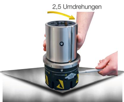
8. Drehen Sie nun die Führung im Uhrzeigersinn wieder um exakt 2,5 Umdrehungen zurück und ziehen Sie den 6 mm Stift heraus.
