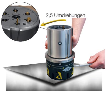
7. Halten Sie die Kopfhülse fest und drehen die Führung gegen den Uhrzeigersinn um 2,5 Umdrehungen. ALLE Gewindeformer sollten sich nun drehen und nach oben bewegen. Sollte dies nicht der Fall sein oder sollte die Führung bei dieser Drehbewegung klemmen, muss das Werkzeug gereinigt werden. Die Module müssen neu kalibriert werden.
