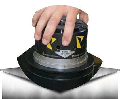
2. Drehen Sie den Kopf um mindestens 360° in 60°-Schritten im Uhrzeiger- und entgegen des Uhrzeigersinns. Der Kopf sollte alle 60° leicht einrasten, jedoch auch leicht wieder auszurasen sein.
