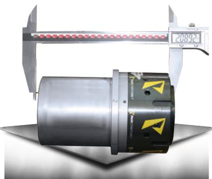
5. Überprüfen Sie nochmals die Gesamtlänge des kompletten Oberteiles ( $L = 209 \text{ mm} \pm 0,3 \text{ mm}$ ) gemessen von Kopf-Innenkontur bis Gewindeformer-Unterkante.
