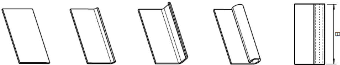
Es werden zwei Werkzeuge benötigt: ein Vorprägewerkzeug und ein Endprägewerkzeug
